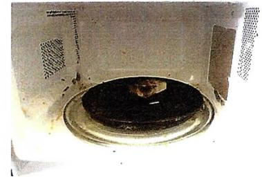
電子レンジ内の状況 (焼き網と焼損した食材)
